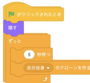
クローンを作成するスクリプト。下記のスクリプトでバーをスクリーンを上から下にスクロールさせるために使用される。
